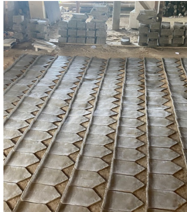
Gambar 1: Atap Singgora dijemur selepas proses pembakaran
